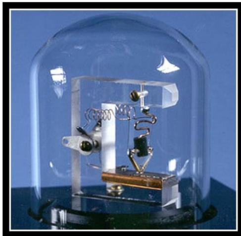
Gambar 1.11. Transistor Shockley yang Mengubah Dunia
