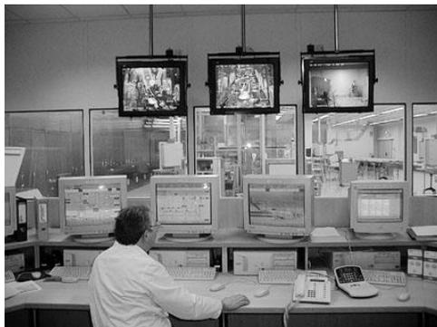
Gambar 3.7. HMI (Human Machine Interface) pada Sistem Kendali
